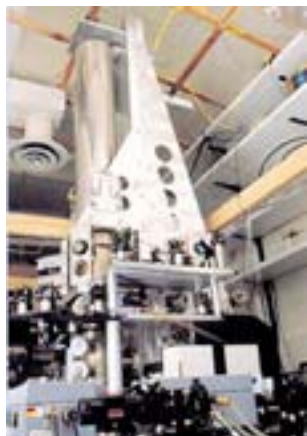
Gambar 8.8 Jam atomik menggunakan atom cesium
