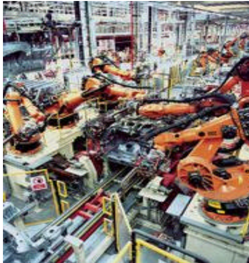
Gambar 1.2. Penggunaan robot dalam otomasi proses (pembuatan mobil)
