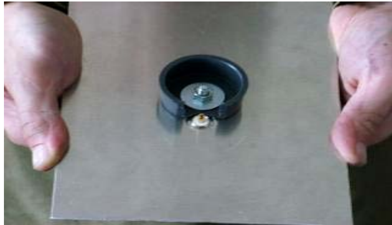
Gambar 3.11. Penggunaan pelat baja tipis sebagai dudukan komponen sensor alat ukur radiasi matahari
