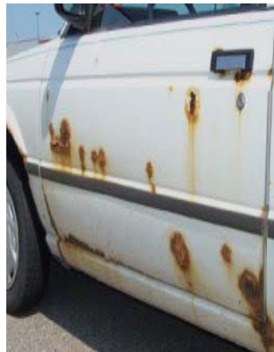
Gambar 3.49. Dinding mobil mengalami korosi
