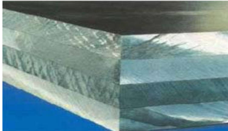
Gambar 3.42. Salah bentuk pelat stainless steel tebal
