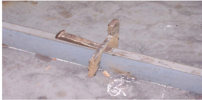
Gambar 19.3 Penekanan deck beam dengan paju
