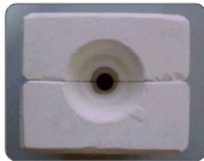
Gambar 20.102 Cetakan disatukan, siap untuk proses penuangan
