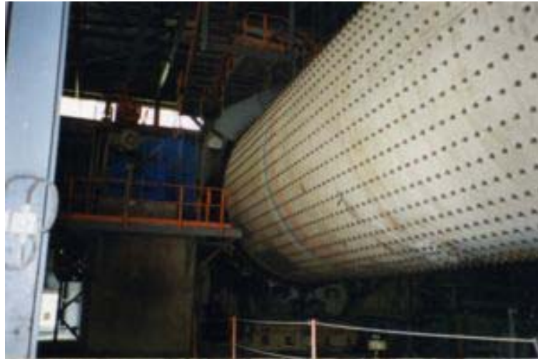
Gambar 20.74 Penggilingan semen, mampu menghasilkan semen 270 ton/jam
