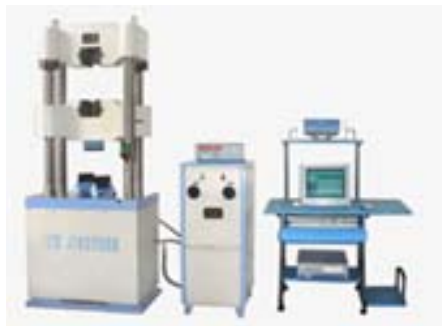
Gambar 13.16. Microcomputer tensile tester untuk menguji kekuatan tensil kemasan
