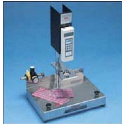
Gambar 13.13. Stiffness tester untuk mengukur ketebalan kemasan
