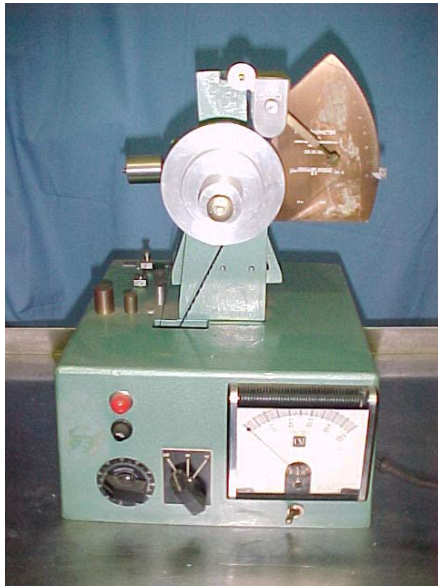
Gambar 13.17. Westover type frictionometer untuk mengukur gaya gesek kemasan
