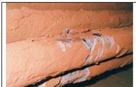
Gambar 17.5. Endapan (putih) yang terbentuk pada saluran air dalam boiler yang menggunakan air dengan nilai kekerasan >20 mg/L
