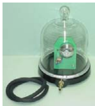
Gambar 9.11b. Bejana lonceng yang dilengkapi dengan pompa penghisap
