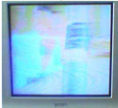
Gambar 6.99: Gambar Tak Jelas Tapi Warna Masih Ada
