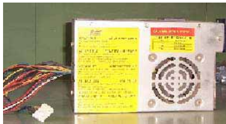
Gambar 6.2: Contoh Regulator Switching Untuk Komputer
