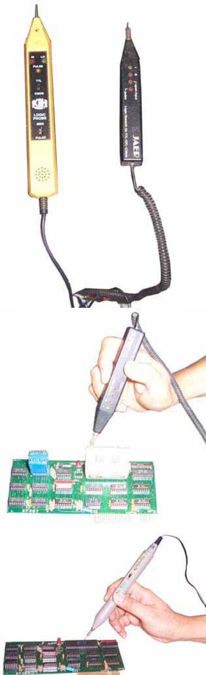
Gambar 5.24: Macam-Macam Logik Probe dan Cara Pengukurannya
