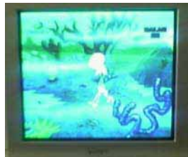
Gambar 6.98:Warna Gambar Ada Yang Hilang.
