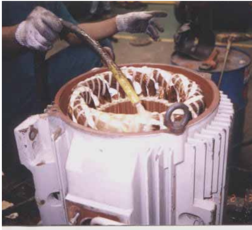
Gambar VI-28 Bentuk Belitan dalam Stator dan Proses Pemvarnisan
