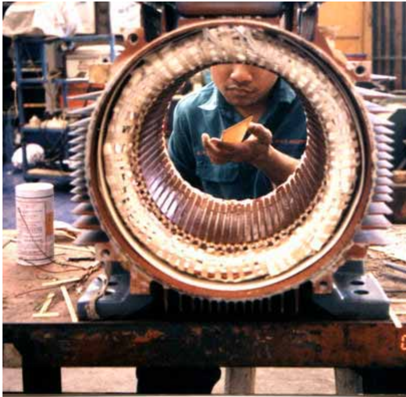
Gambar VI.27 Pemasukan Belitan ke dalam Alur Stator
