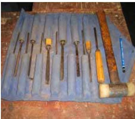
Gb. 9.1: Peralatan Tangan yang Digunakan untuk Membuat Komponen Inlay
