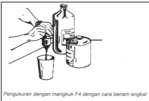
Gb. 10.18. Mengukur Viscositas dengan Ford Cup 4 secara benam angkat
