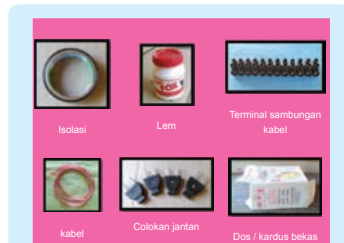
Gambar 2.18 Bahan untuk membuat papan instalasi listrik menggunakan sakelar.
