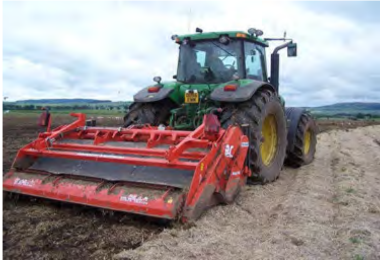
Gambar 49. Proses pengolahan tanah dengan bajak rotari
