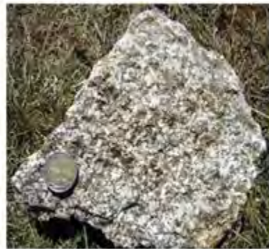
Gambar : Batuan beku plutonik , Jenis batuan beku asam, nama : batu Granodiorite
