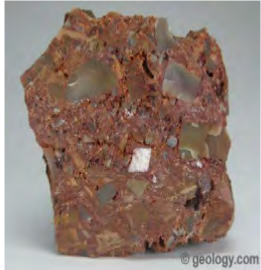
Gambar 1.56 Batuan sedimen Klastik Golongan Detritus kasar : Batu Breksi. Perhatikan fragmen batuan yang relative menyudut ( angular )
