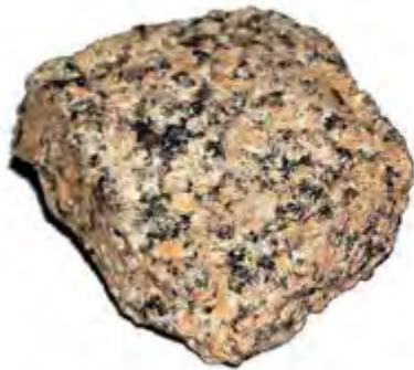
Gambar : Batuan beku plutonik , Jenis batuan beku asam, nama : batu Granit
