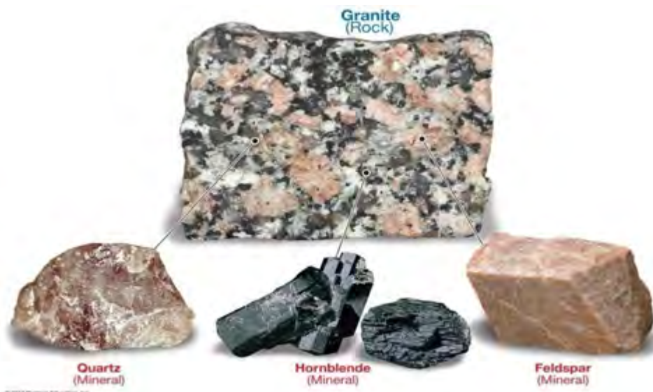
Gambar. Batuan beku Granit dengan kandungan mineral mineralnya .
