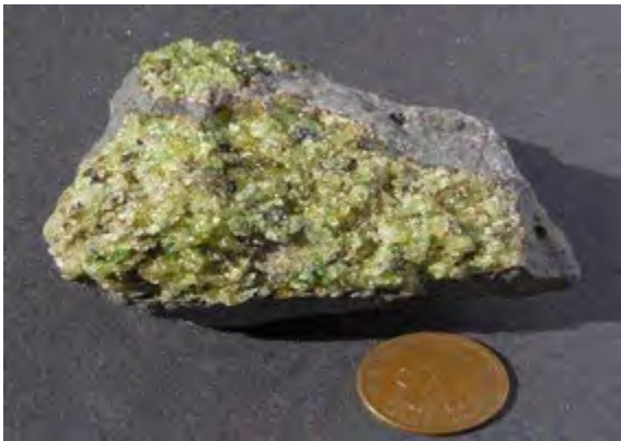
Gambar : Batuan beku plutonik , Jenis batuan beku ultrabasa , nama : batu Dunite
