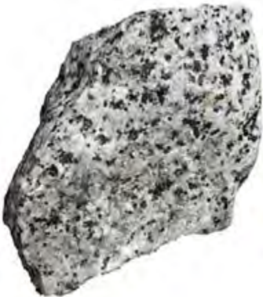
Gambar : Batuan beku plutonik , Jenis batuan beku asam, nama : batu Granodiorite
