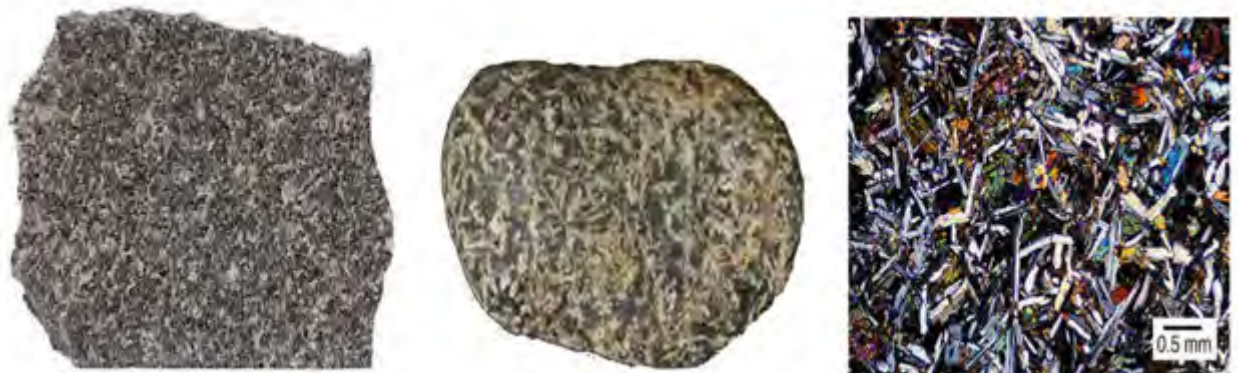
Gambar : Batuan beku plutonik , Jenis batuan beku basa, nama : batu Diabas
