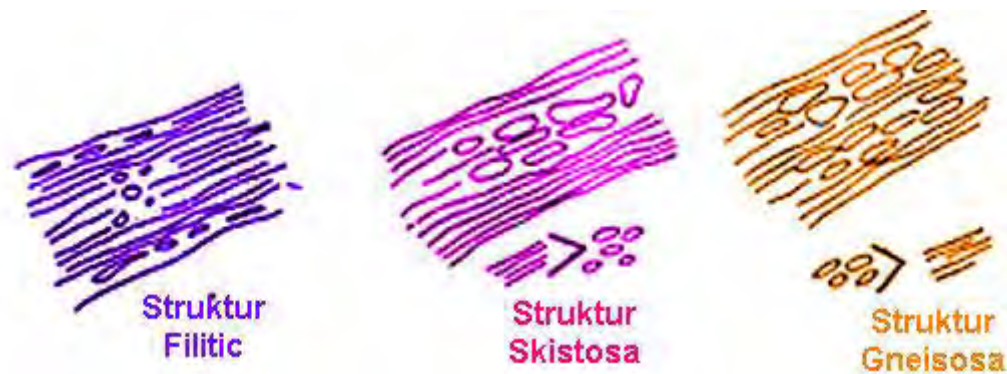
Gambar 1.92. Struktur Foliasi pada batuan metamorf
