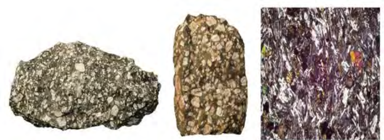
Gambar : Batuan beku vulkanik, Jenis batuan beku intermediate, nama : batu Trakhit
