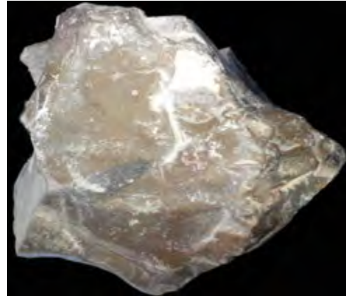
Gambar 1.57. Batuan sedimen Klastik Golongan Detritus halus , batulempung, perhatikan tidak tampak bidang perlapisannya dan perhatikan pula pecahannya yang membulat (konkoidal) sebagai ciri khas batulempung.
