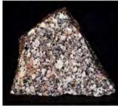
Gambar : Batuan beku plutonik , Jenis batuan beku asam, nama : batu Granit
