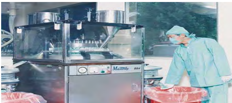
Gambar 2.5: Pengisian kapsul dengan mesin
