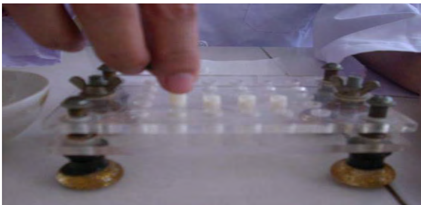
Gambar 2.4: Pengisian kapsul dengan alat bukan mesin
