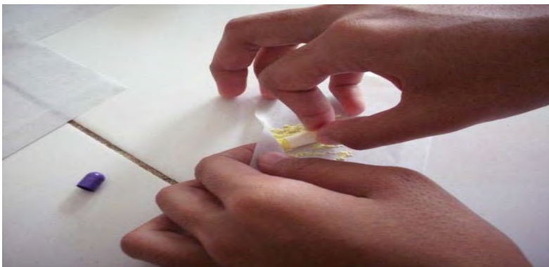
Gambar 2.3: Pengisian kapsul dengan tangan
