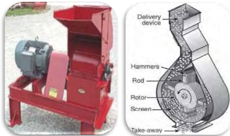
Gambar 39. Hammermill dan Penampang Bagian Dalamnya.
