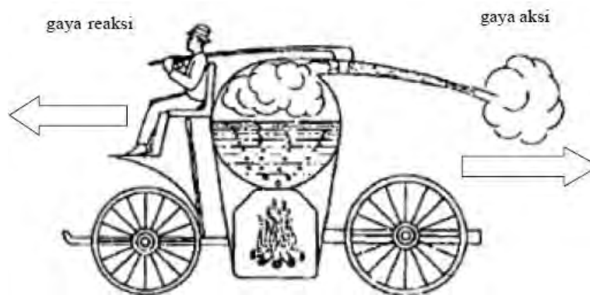
Gambar 2.86 Mesin uap Newton gaya aksi reaksi
