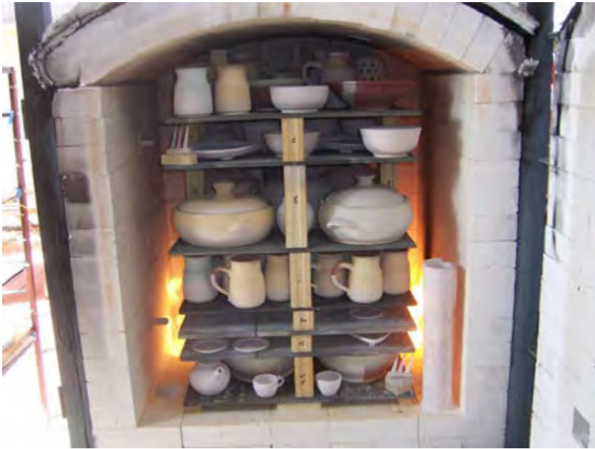
Gambar 39. Membakar dengan tungku gas (Sumber: www.dapottery.com )
