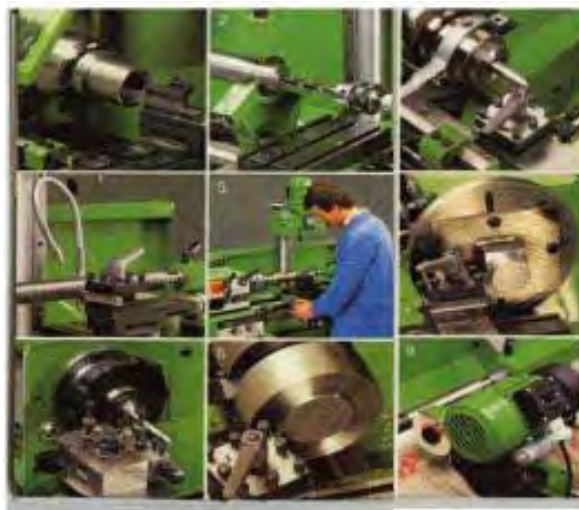
Gambar 5.39. Beberapa contoh proses bubut dengan cara pencekaman/pemegangan benda kerja yang berbeda-beda
