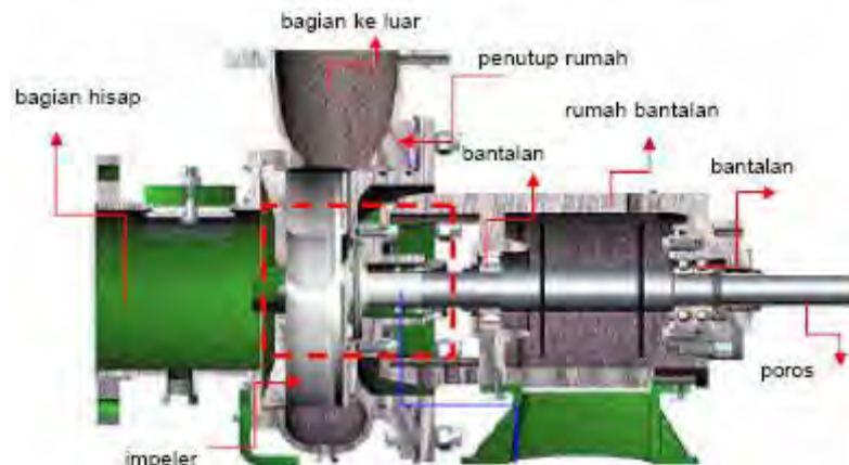
Gambar 3.62 Konstruksi pompa khusus
