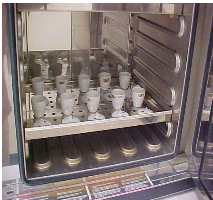
Gambar 18. Posisi meletakkan tutup dan cawan porselen dalam oven(kondisi M_1 , dan M_2 ).
