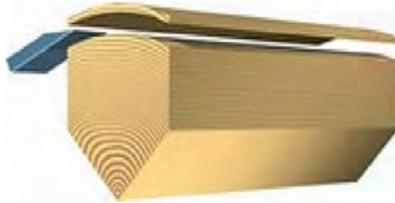
Gambar 3. Cara Pembuatan Finir dengan Metode Half-Round Slicing
