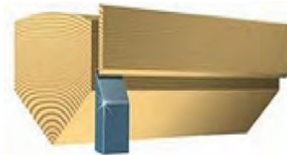
Gambar. Cara Pembuatan Finir dengan Metode Quarter Slicing (Sumber :
