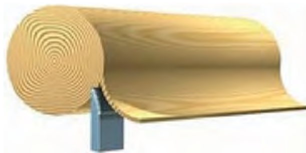
Gambar Cara Pembuatan Finir dengan Metode Pengupasan (Sumber : http://www.tentangkayu.com/2008.html )
