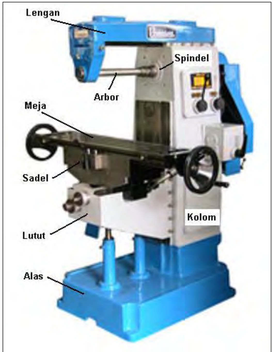
Gambar 1 Mesin Frais
