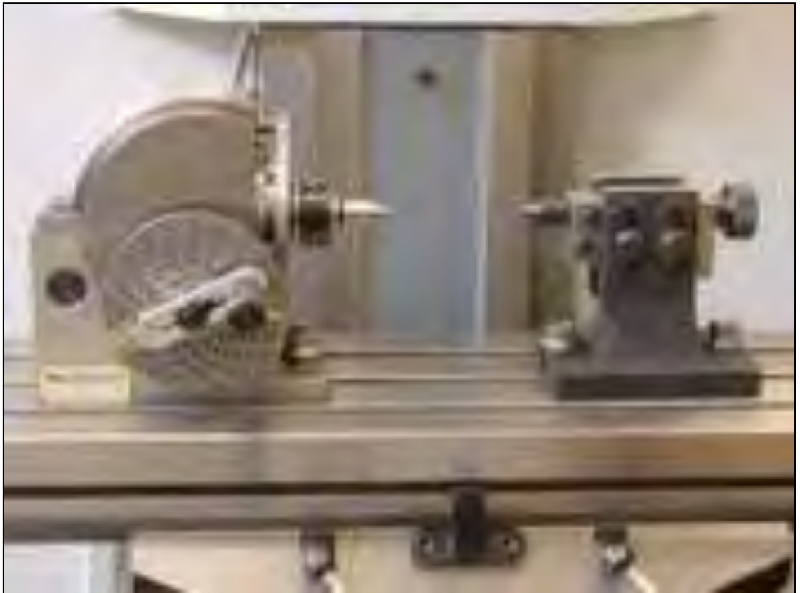
Gambar 24 Pemasangan Kepala Pembagi
