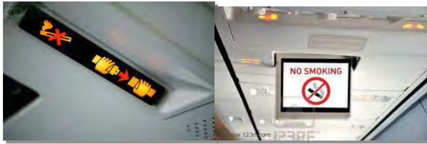
Gambar 7.2 (lampu petunjuk pada kabin pesawat)
