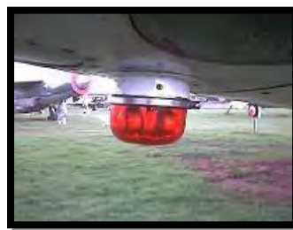
Gambar 7.12 (Anti Collision pada posisi lampu di atas)
