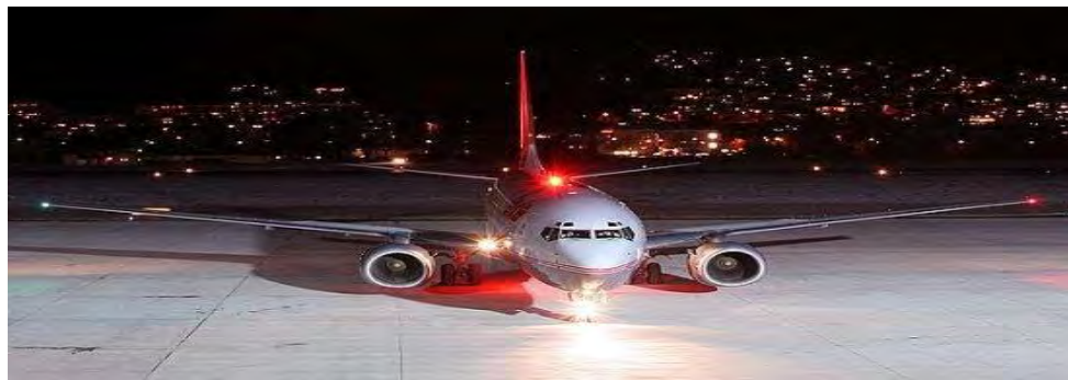
Gambar 7.11 (Anti Collision pada posisi lampu di atas)
