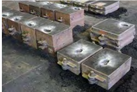
Gambar 10 Contoh cetakan pasir Sumber: http://elmuhandis.wordpress.com
