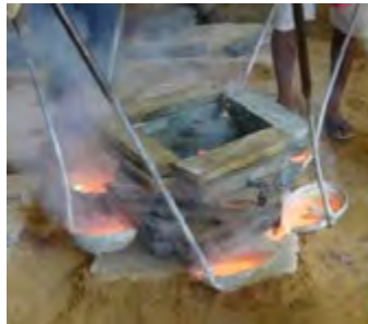
Gambar 2 Menuang logam cair pada cetakan Sumber: http://www.coroflot.com
