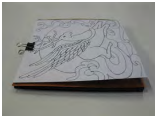
Gambar 31. Menempel gambar pola di atas plat Sumber; Dokumen studio logam, 2013
