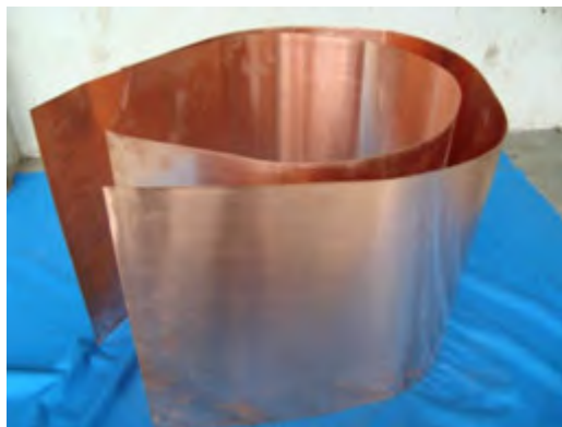
Gambar 2. Plat tembaga ketebalan 0,2 mm Sumber; Dokumen pribadi, 2012
