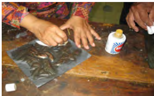
Gambar 41. Mengkilapkan benda kerja dengan cara digosok kain braso Sumber; Dokumen studio logam, 2013
