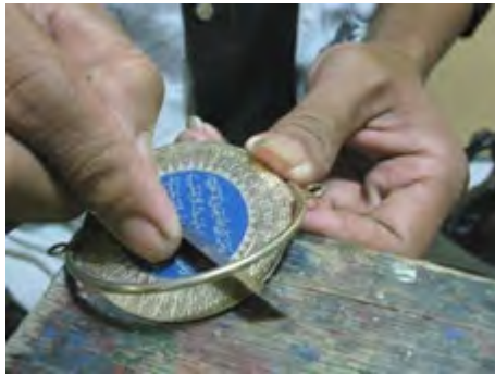
Gambar 68. Mengerok cat Sumber; Dokumen studio logam, 2013
