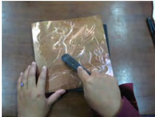
Gambar 34. Mencembungkan motif Sumber; Dokumen studio logam, 2013
