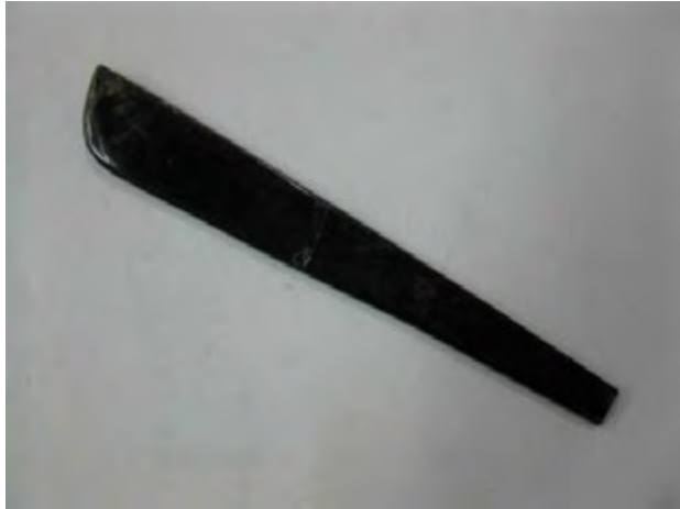
Gambar 16. Penekan plat bagian sudut agar cekung /cembung Sumber; Dokumen studio logam, 2012
