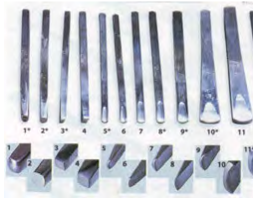
Gambar 20. Pahat Logam Penguku , Pemudul dan Perata Sumber; Dokumen studio logam, 2012
