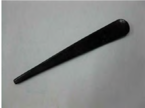
Gambar 14. Penekan plat agar cekung /cembung Sumber; Dokumen studio logam, 2012
