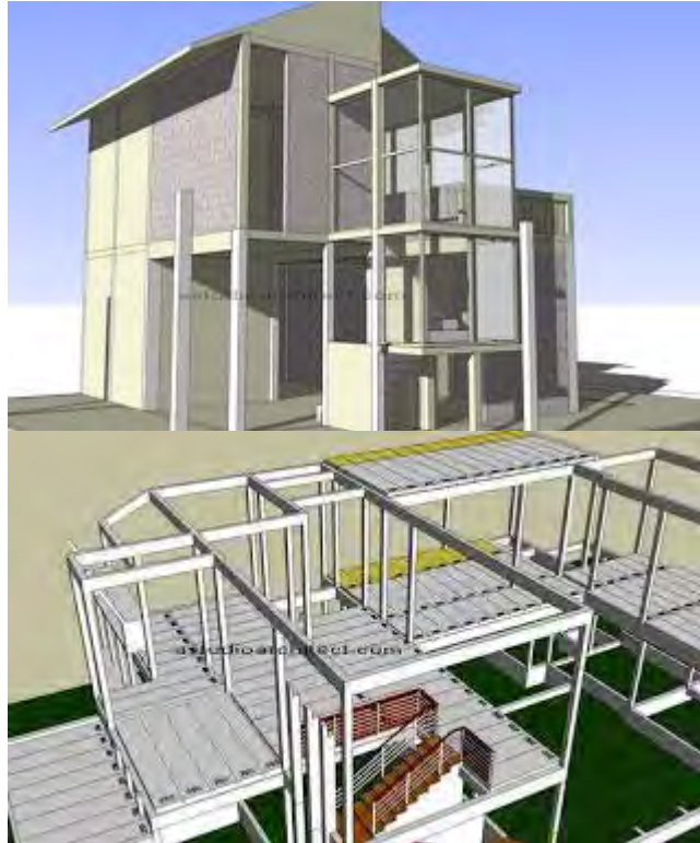
Gambar 5. 17 gambaran struktur kolom menggunakan beton bertulang. Pada dasarnya merupakan rangka yang menopang beban seluruh bangunan.
