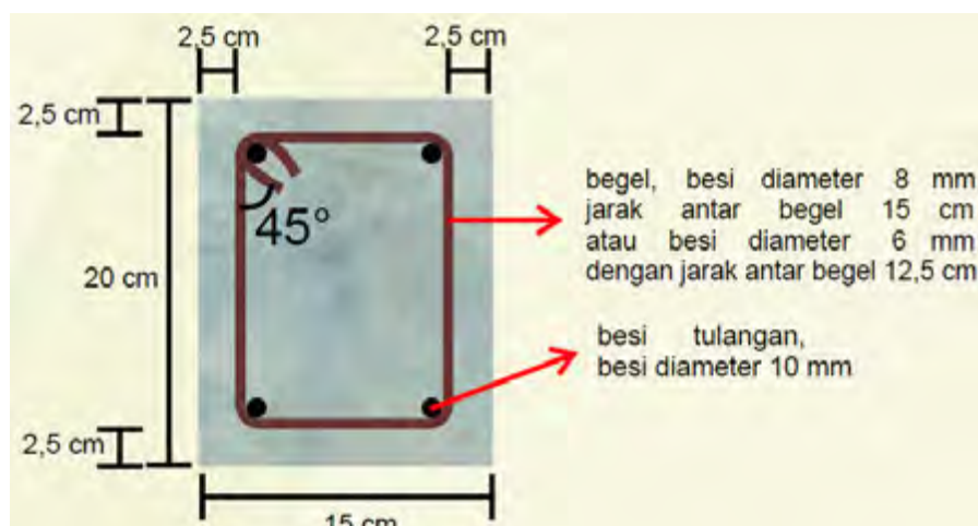
Gambar 5. 10 Pembuatan begel sloof
