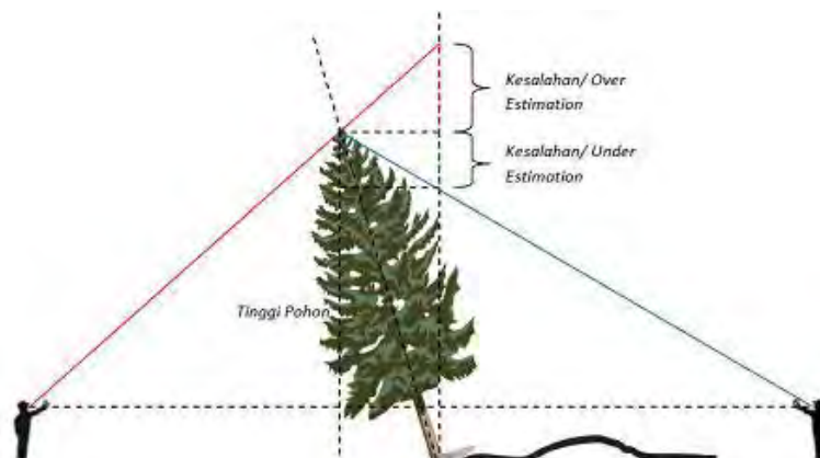
Gambar 24. Pohon miring mengakibatkan kesalahan ukur
