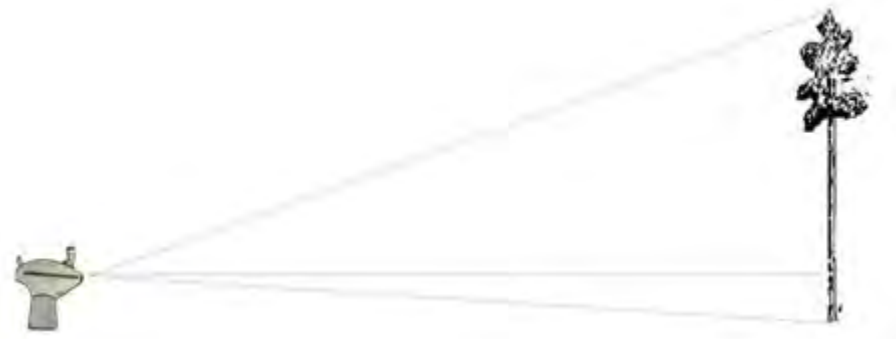
Gambar 56. Prinsip kerja Hagameter
