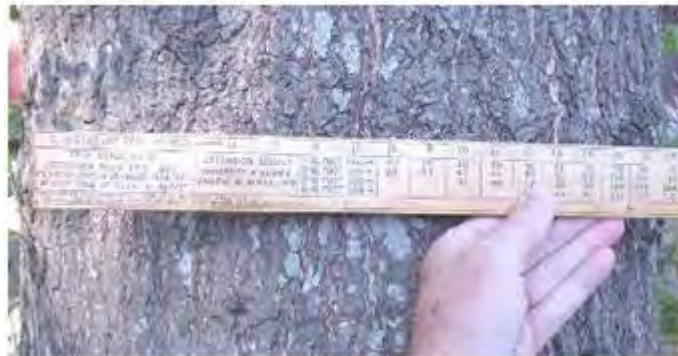
Gambar 41. Cara menggunakan Biltmore Stick
