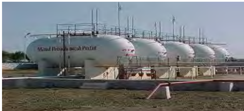
Gambar 24. Tangki penyimpanan bahan baku gas yang berbentuk elips bulat telur. ( www.bharattanksandvessel.com ).
