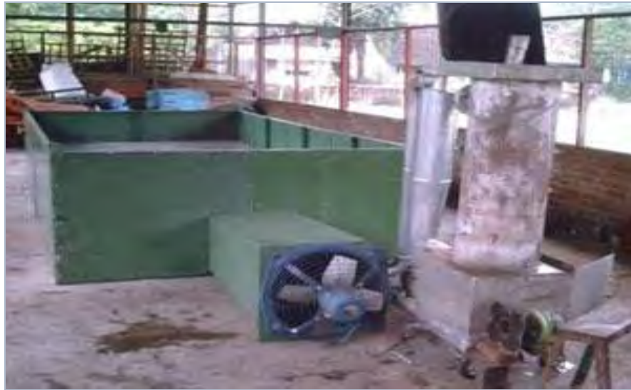
Gambar 98. Pengering gabah sederhana
