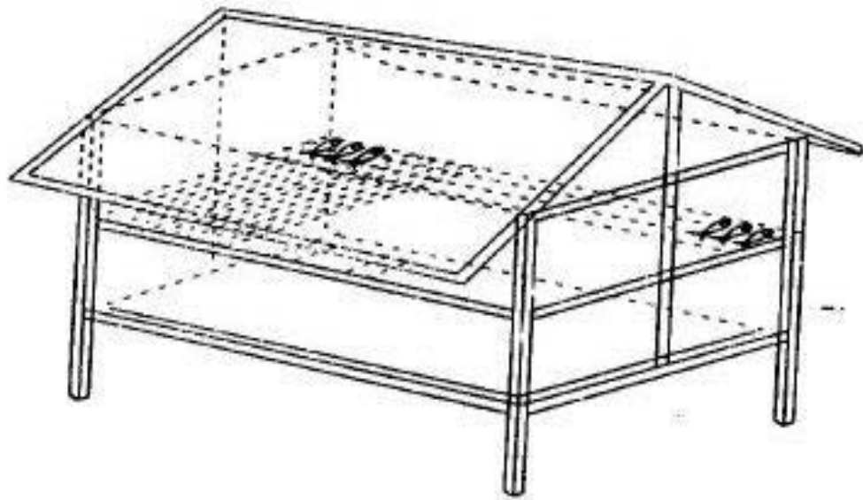
Gambar 24. Alat pengering surya bentuk rumah
