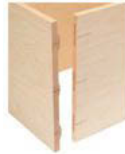
Gambar 7.26. Cara membuat sambungan konstruksi sudut
