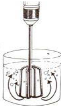
Gambar 5.36. Pengadukan dengan mesin bor
