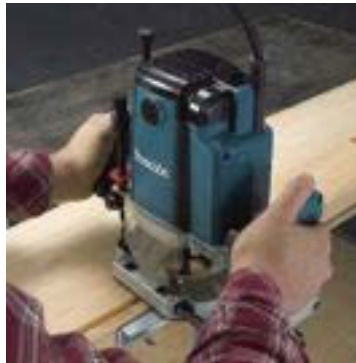
Gambar 6.18 Penampang pembuatan sponing
