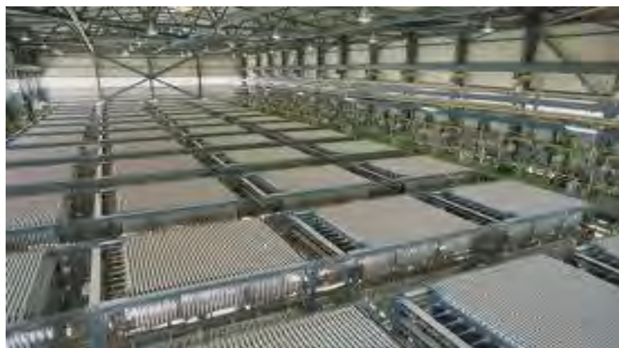
Gambar 35. Proses Pembuaatan Gas Chlorine, Gas H 2 Dan Larutan Soda Kostik
