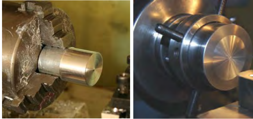
Gambar 4.4. Pemasangannya benda kerja berukuran pendek sebelum dibubut permukaannya
