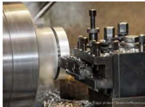
Gambar 4.38. Proses pemotongan benda kerja berukuran pendek.
