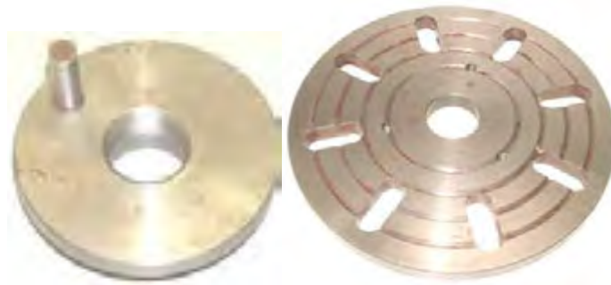
Gambar 1.25. Pelat pembawa permukaan bertangkai dan Pelat pembawa rata
