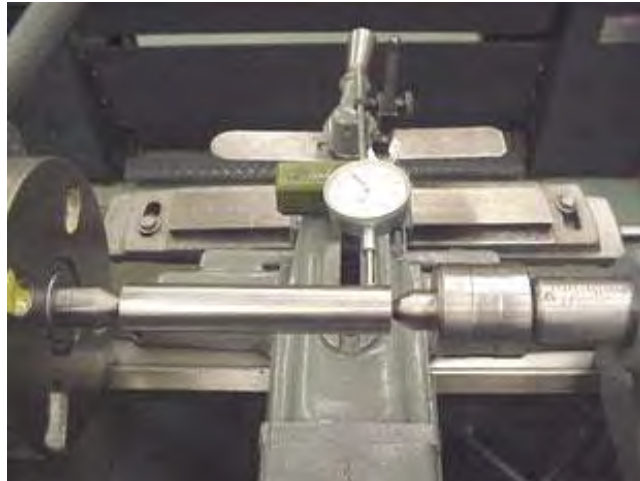
Gambar 4.10. Mengatur keseputan sumbu dengan alat bantu batang pengetes dan dial indikator
