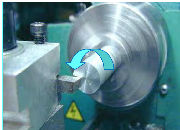
Gambar 4.5. Pembubutan permukaan start pahat bubut diawali dari sumbu senter benda kerja
