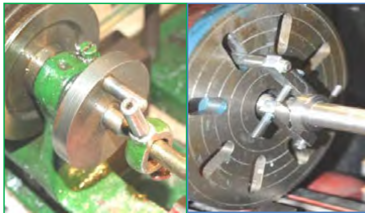
Gambar 1.26. Penggunaan pelat pembawa bertangkai dan berlalur pada proses pembubutan
