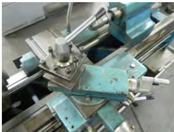
Gambar 4.27. Pengaturan pergeseran eretan atas berdasarkan hasil perhitungan
