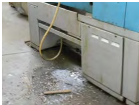
Gambar 473. Membiarkan air pendingin dan tatal berserakan
