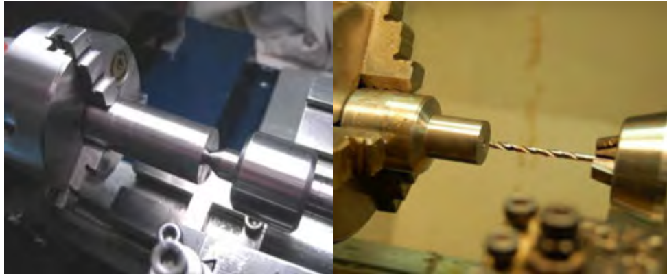
Gambar 4.9. Fungsi lubang senter bor sebagaiudukan senter putar dan pengarah pengeboran
