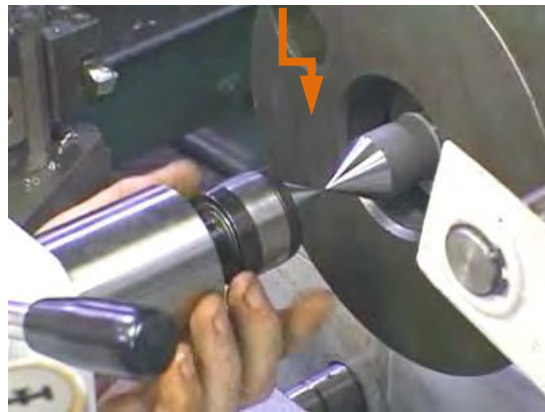
Gambar 4.11. Mengatur keseputan sumbu senter dengan mempertemukan kedua ujung senter
