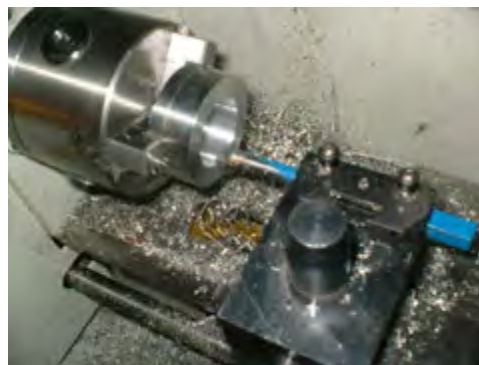
Gambar 4.63. Proses pembubutan diameter dalam
