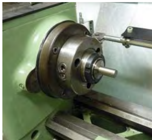
Gambar 1.24. Pemasangan benda kerja pada kolet
