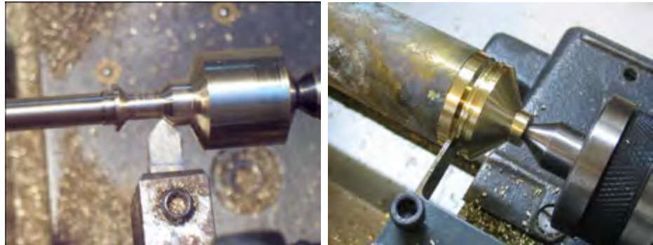
Gambar 4.34. Pengaluran benda kerja dengan pendukung senter putar
