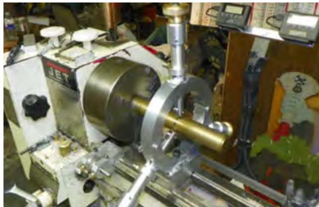
Gambar 4.40. Menahan benda kerja sebelum dipotong dengan steady rest
