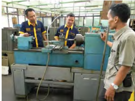
Gambar 472. Bekerumunan disekirtar mesin bubut yang sedang beroperasi, tanpa menggunakan pakaian kerja dan alat keselamatan kerja.
