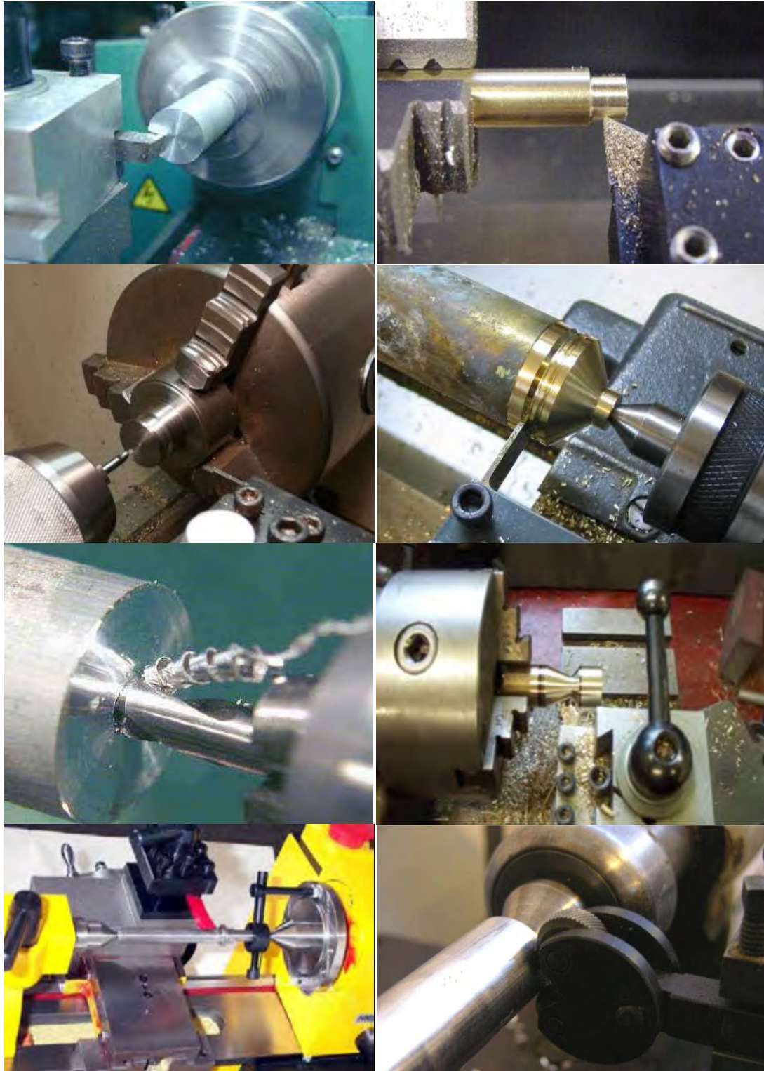
Gambar 3.1. Berbagai proses pembubutan
