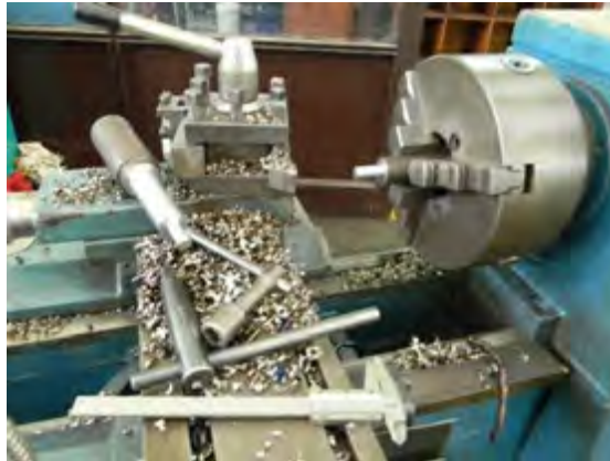
Gambar 470. Penempatan peralatan kerja yang tidak aman
