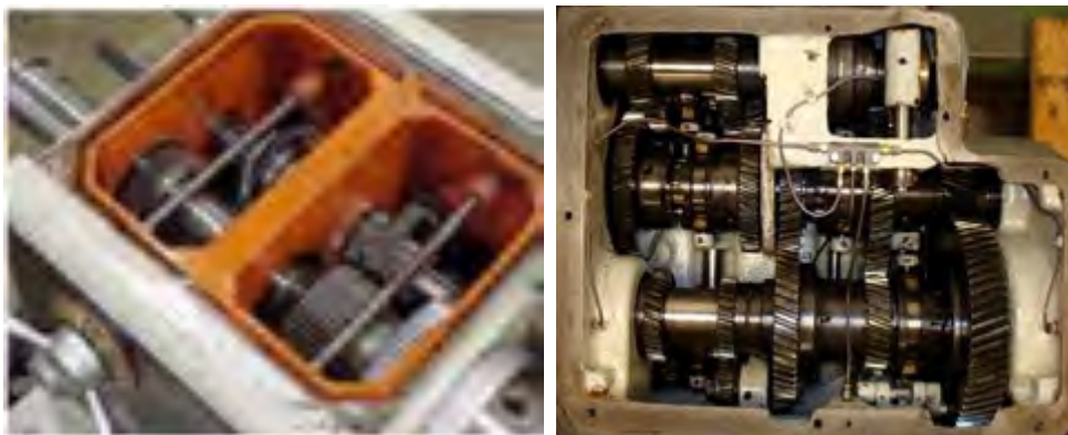
Gambar 1.5. Gear box pada kepala tetap
