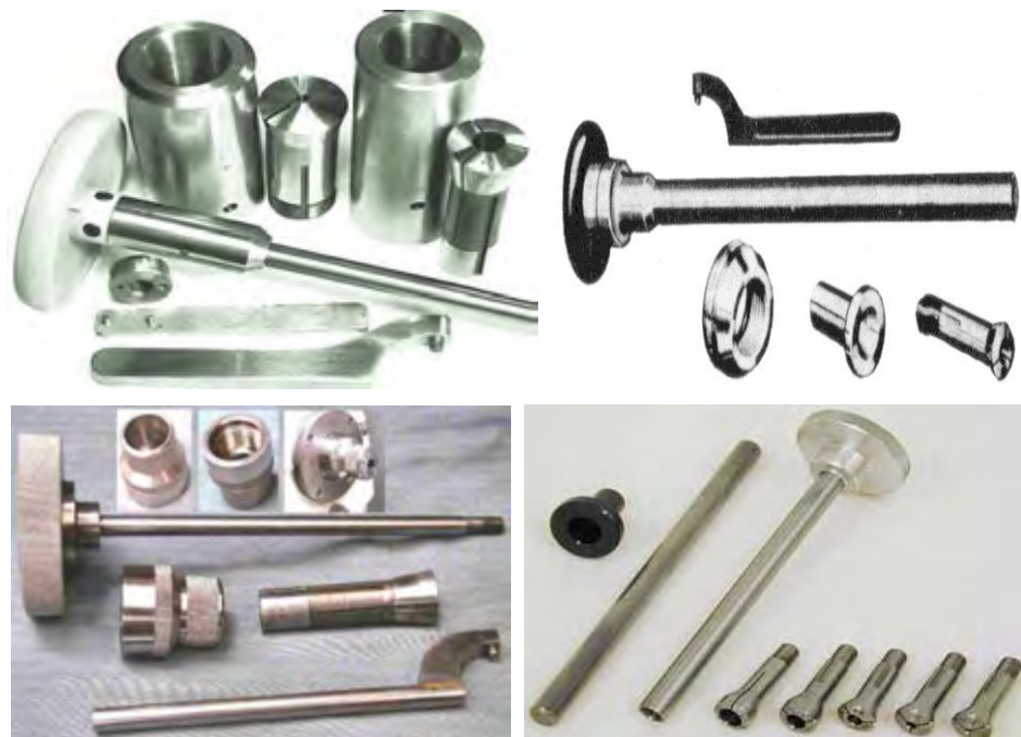
Gambar 1.21. Cekam kolet dengan batang penarik
