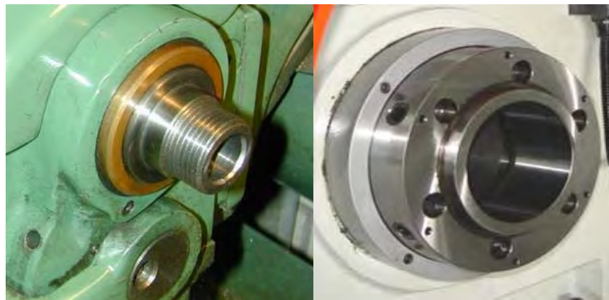
Gambar 1.19. Bentuk dudukan/pengarah pada spindel mesin bubut
