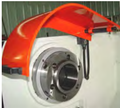
Gambar 1.3a. Spindel utama mesin bubut
