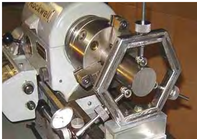
. Gambar 4.4. Pemasangannya benda kerja berukuran panjang sebelum dibubut permukaannya
