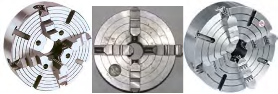
Gambar 1.16. Cekam rahang empat tidak sepusat ( independent chuck ).
