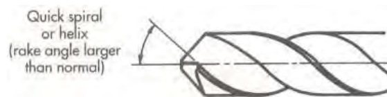
Gambar 2.14. Mata bor spiral pendek/ quick spiral
