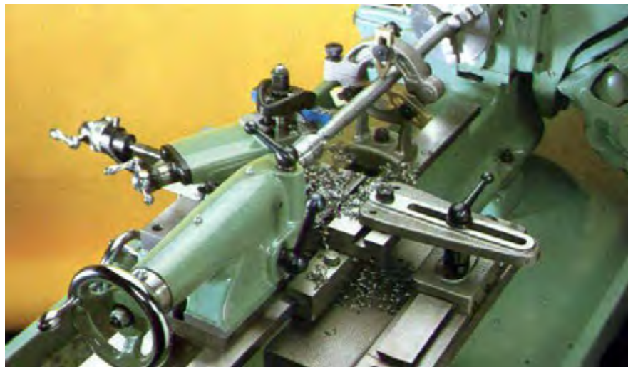
Gambar 4.18. Pembubutan lurus benda kerja ditahan dengan senter putar dan tengahnya ditahan dengan steady rest
