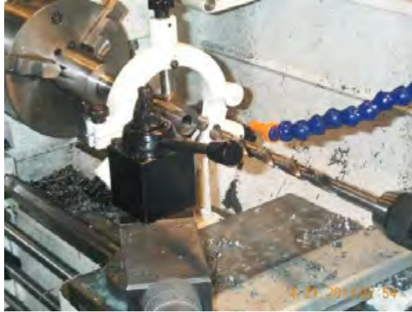
Gambar 4.62. Proses pengeboran pada mesin bubut
