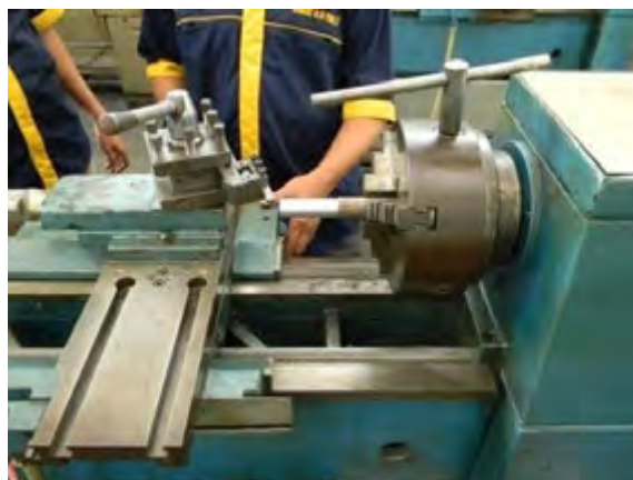
Gambar 471. Menempatkan kunci cekam pada mulut pengencang cekam setelah melepas benda kerja
