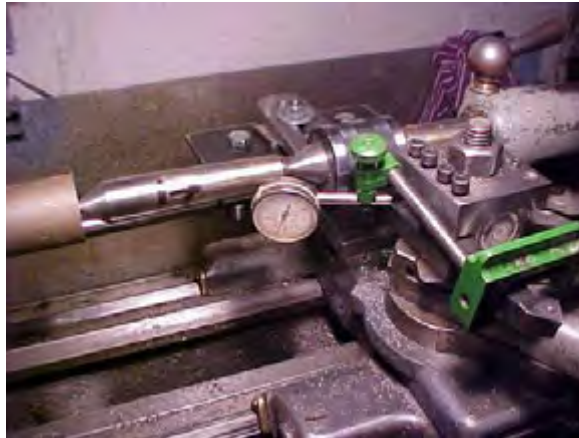
Gambar 4.28. Pengaturan pergeseran eretan atas berdasarkan batang tirus standar
