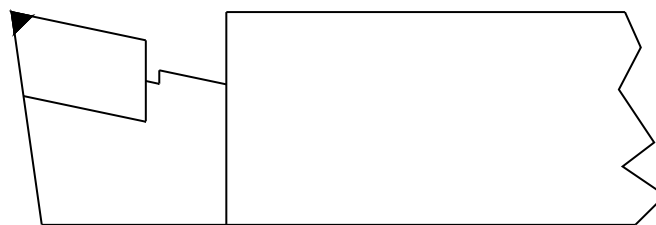
Gambar 2.82. Pembentukan radius pada ujung pahat
