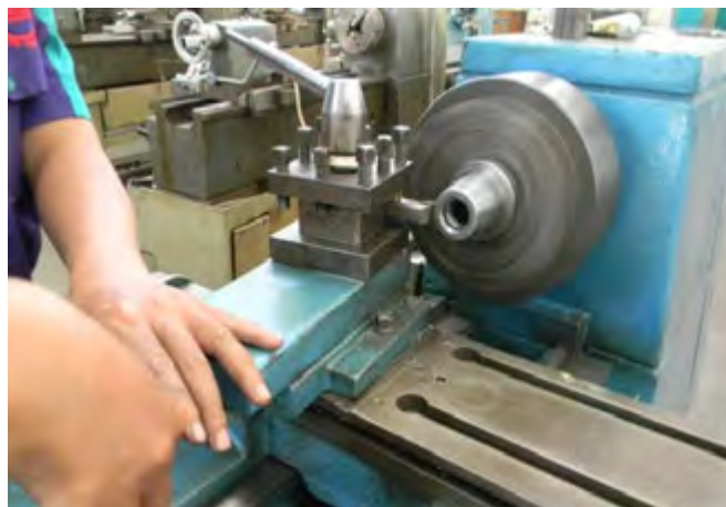
Gambar 4.22. Pembubutan tirus dengan menggeser eretan atas
