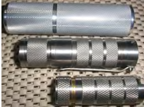
Gambar 4.65. Contoh hasil pengkartelan
