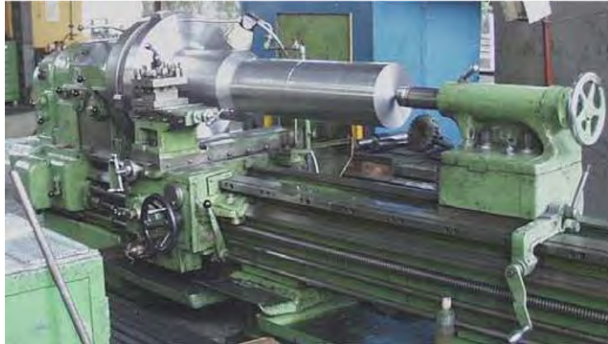
Gambar 4.17. Pembubutan lurus, benda kerja ditahan dengan senter putar
