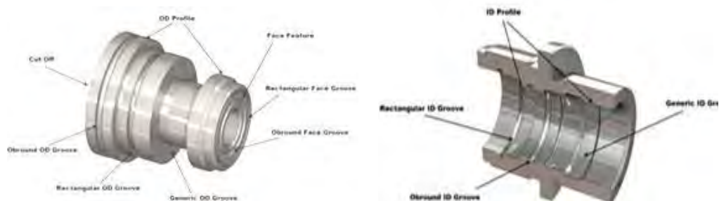
Gambar 4.29. Pengaluran dengan berbagai posisi
