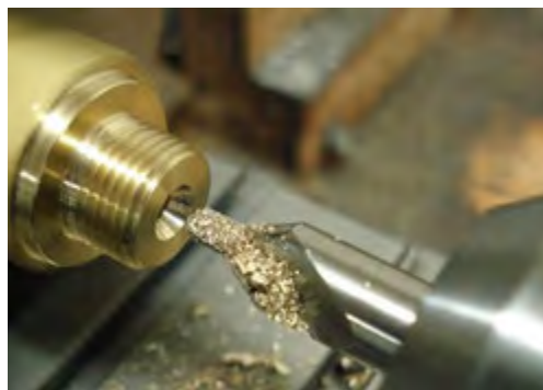
Gambar 4.8. Pembubutan lubang senter pada permukaan ujung benda kerja
