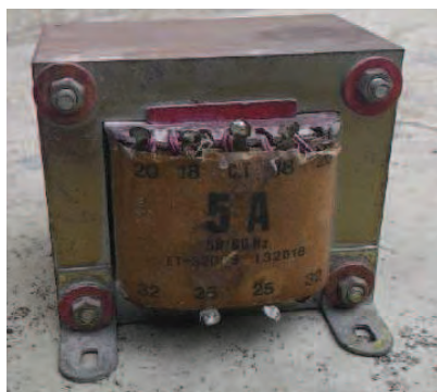
Sumber: Dokumen Kemdikbud Gambar 6.36 Transformator
