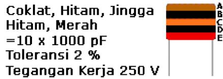
Gambar 13. Kode Warna pada Kapasitor
