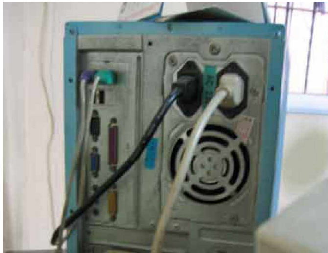
Gambar 30. Pemasangan Kabel Power
